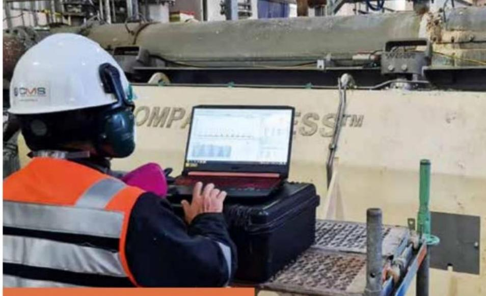
La empresa es representante en Chile de la firma sueca SPM Instrument AB, creadora de una tecnología pionera en el mundo para el monitoreo del estado mecánico del rodamiento y sus condiciones de lubricación, detectando de forma anticipada fallas incipientes con tiempos de pre-aviso amplio. Puede ser aplicada en todo tipo de activos rotatorios.
